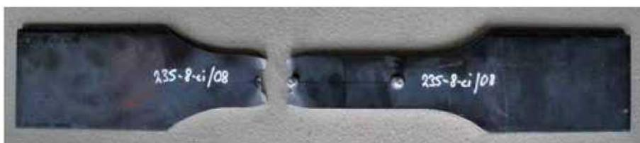
Образец для усталостных испытаний
