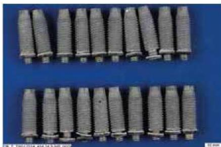
Снятый крепеж S-BT после 12-недельного циклического испытания на предмет коррозии согласно EN ISO 16701. Видимая коррозия отсутствует.
