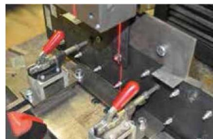
Установка для проведения испытания в условиях сдвигающих нагрузок
