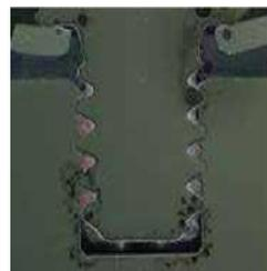
Механизм крепления шпильки S-BT в стали
