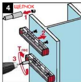
4 Установите профиль на шпильки S-BT и удерживайте его на месте. Затяните гайки, соблюдая соответствующий момент затяжки.
