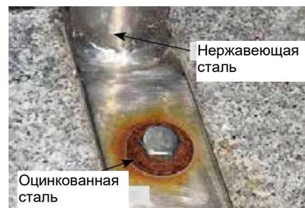
Это стандартный пример контактной коррозии. Оцинкованная углеродистая сталь (шайба) использовалась совместно с нержавеющей сталью (винт и деталь). Благородный металл (нержавеющая сталь) имеет большую площадь поверхности, что привело к серьезной коррозии шайбы.
