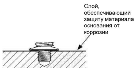
Толщина слоя, обеспечивающего защиту материала основания от коррозии,  $\leq 0,8 \text{ мм [0,0315"]}$ . При наличии покрытий с большей толщиной свяжитесь с компанией Hilti.
