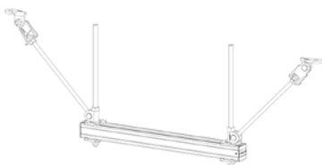
Сейсмостойкое крепление в поперечном направлении
