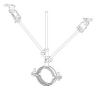
Сейсмостойкое крепление в поперечном направлении
