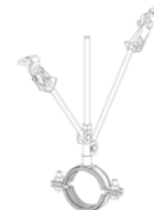
Сейсмостойкое крепление в продольном направлении
